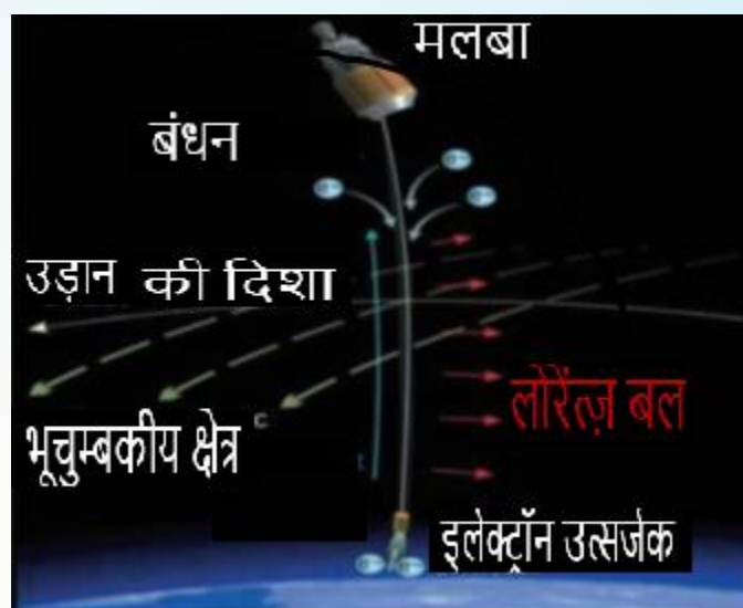
आकृति-3: टीथर आधारित: इलेक्ट्रोडायनामिक टीथर (ईडीटी) तकनीक की कार्यविधि [6]
