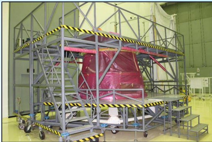
चित्र 9: टीवी-डी1 मिशन के लिए कू मॉड्यूल के आसपास समाकलन प्लेटफॉर्म इकट्ठे किए गए
