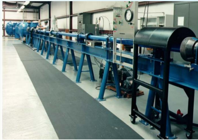
चित्र 9: WSTF .50 कैलिबर दो-चरण लाइट-गैस गन [7]
