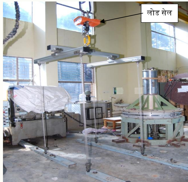
चित्र 6 पूर्ण प्रहस्तन प्रणाली के लिए परीक्षण सेटअप
