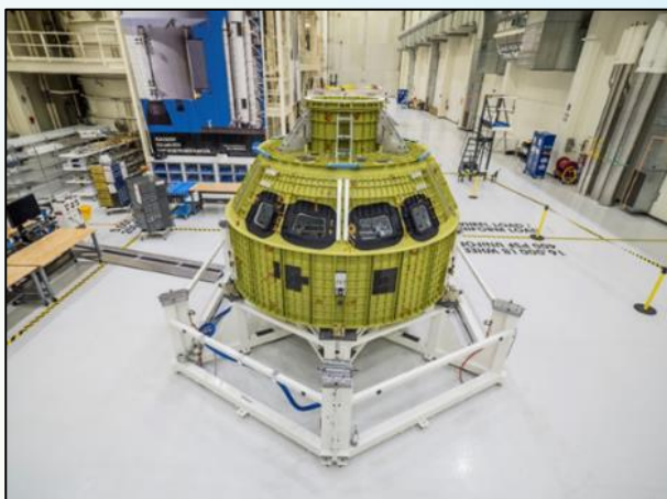
चित्र 3: ओरियन कू मॉड्यूल ढांचे की एक सपोर्ट फिक्स्चर के साथ इंटरफेस किया गया [2]
